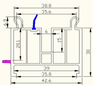
Montážní a přepravní profil Metal-Plast je určen pro správné provedení montáže a izolace okna a upevnění parapetů.
