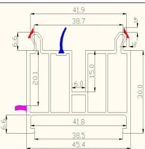
Montážní a přepravní profil Metal-Plast je určen pro správné provedení montáže a izolace okna a upevnění parapetů.
